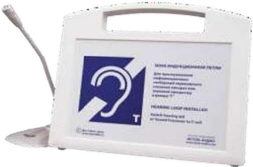
Система информационная для слабослышащих переносная (портативная) (далее переносная система), предназначена для передачи аудиоинформации лицам с нарушенной функцией слуха при повышенном уровне окружающего шума или при наличии преграды между собеседниками, в общественных местах, в зонах
